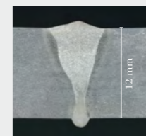
/ Läpihitsattu yhdeltä puolelta, ei sauman valmistelua
