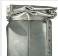
/ Teräs/alumiini-hybridiliitos / Läpäissyt törmäystestin
