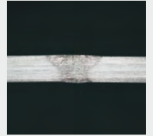
/ Erinomainen ulkonäkö / Samoissa ei huokosia / Plasma – 1: 210 A, U: 21.5 V, Vhiti: 50 cm/min Materiaali: CrNi 3 mm
