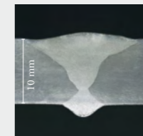
/ Samanaikaisesti Time Twin (PA) ja CMT (PE) / Ei sauman valmistelua / Minimaalinen vääristymä
